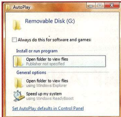
Figure 7 : Présentation de l'autoRun sous Vista, avec un fichier autorun.inf malicieux
